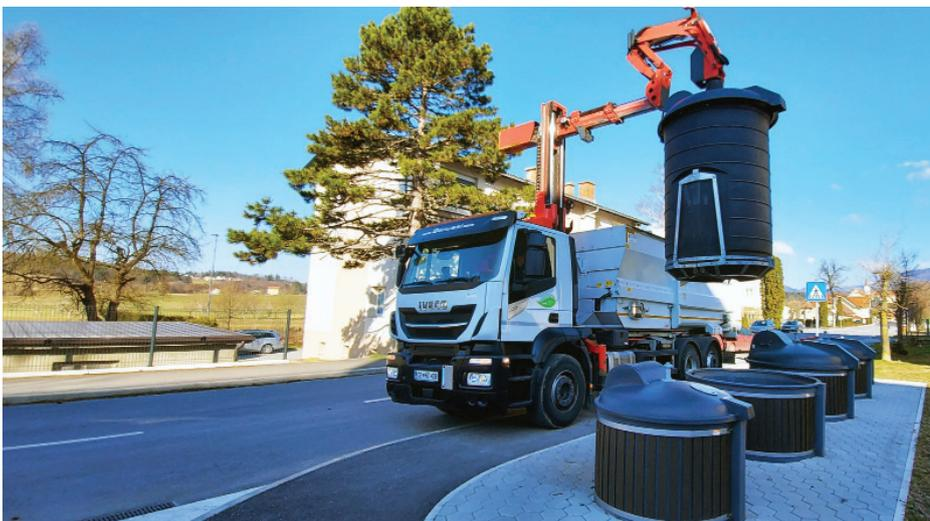
Die ECOdip-Lösung ermöglicht, dass nur ein Bediener für den Entleerungsvorgang erforderlich ist. Der BIG BAG oder die PE- oder Metalleinlage bleibt trocken und sauber, was eine hygienischere Arbeitsumgebung für Bediener und Benutzer gewährleistet.
